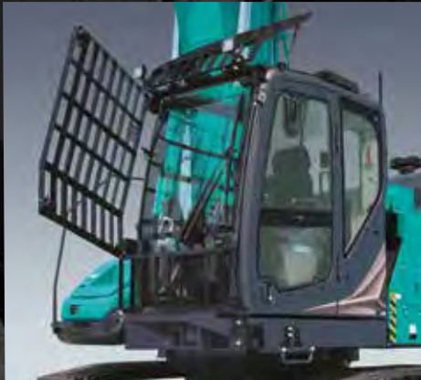
Kabinenschutzgitter (obere Frontscheibe und Dachfenster) kann zum Reinigen leicht geöffnet/geschlossen werden
