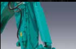
Schutz des Löffelzylinders Verhindert, dass der Zylinder durch herabfallenden Schutt beschädigt wird.
