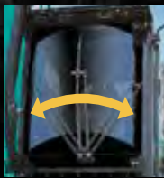
36 % größere Wischfläche des Frontwischers (im Vergleich zur Standardkabine)
