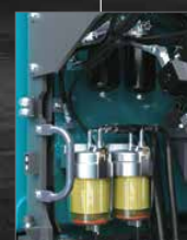
Vorfilter mit integriertem Wasserabscheider
