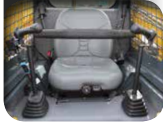
STEUERUNGEN (HIER: RT165)
