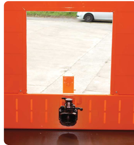
Stirnwand aus Stahlblech mit Langlöchern für die Anbringung einer Kupplung in verschiedenen Positionen, Anbau einer Rockinger Kupplung mit möglicher Fernauslösung an der Stirnwand und Fenster zum Durchgreifen (Zusatzausstattung)
