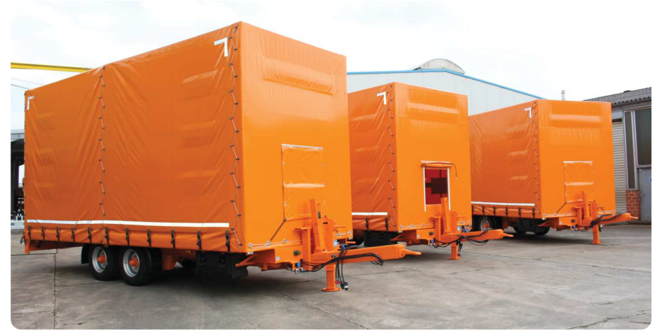
Fenster zum Durchgreifen für das Lösen der Kupplung von vorne, verschließbar durch Rollo, mit Aufstiegshilfe an der Stirnseite, höhenverstellbare Zugdeichsel (teilweise Zusatzausstattung)
