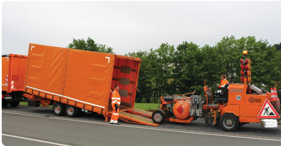
Schnelle und einfache Verladung einer Straßenmarkierungsmaschine: Maschine wird nach der Auffahrt vorne an der Stirnwand automatisch durch Maulkupplung verriegelt und gesichert
