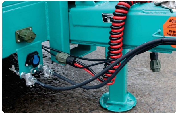
Spiralkabel mit NATO-Stecker, Zuleitung zum Zugfahrzeug
