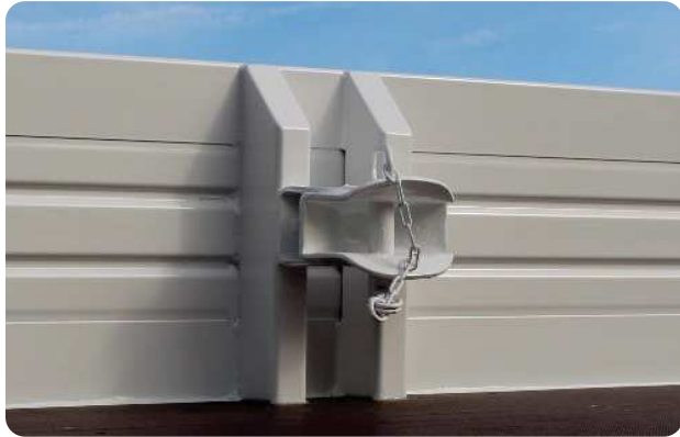
Einfache Rangierkupplung mittig an der Stirnwand angebaut, zur Fixierung der Straßenmarkierungsmaschine
