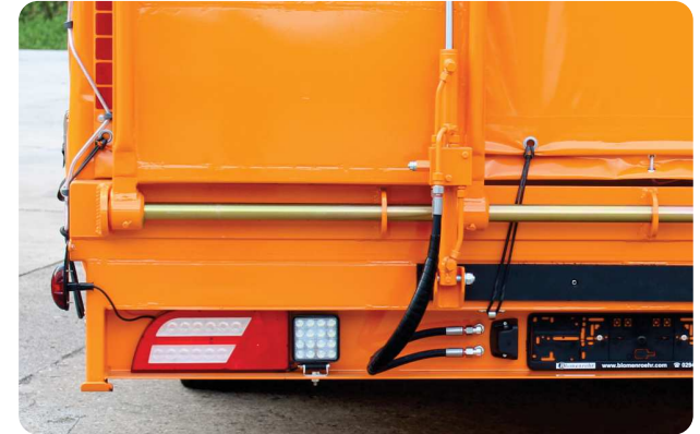
Voll-LED-Lichtanlage 24V, zusätzliche LED-Rückfahrcheinwerfer, Rampen verbreitert auf 80cm, ganz zusammenschiebbar, mit Gasdruck-Rampenhebern
