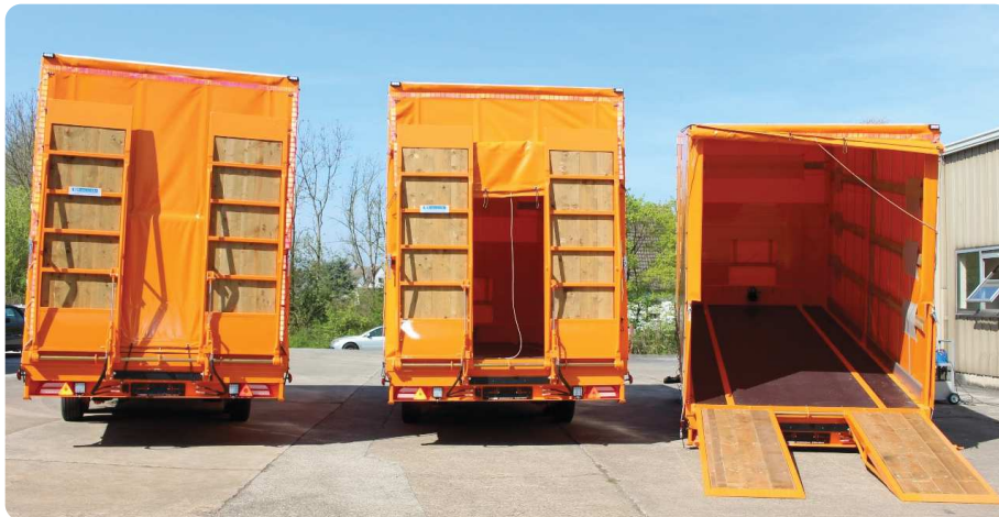
Heck und Innenansicht: Heckrollo, Blitzleuchten am Aufbau, zusätzl. LED-Rückfahrcheinwerfer, Voll-LED-Beleuchtung, verbreiterte Rampen auf 80cm – ganz zusammenschiebbar (teilweise Zusatzausstattung)
