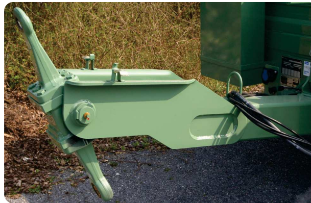
Schwenkopf mit wahlweise 40mm und 50mm Zugösen
